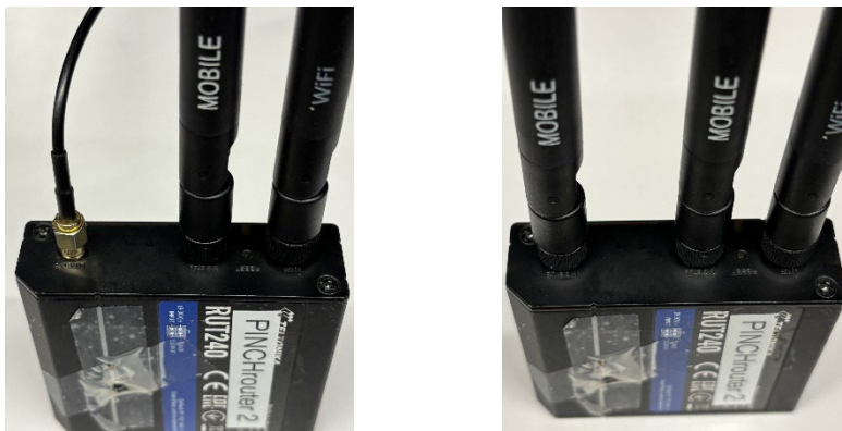
Abbildung 3: Mobile Router mit externer Antenne (links) mit kurzer Antenne (rechts)
